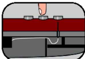
Кабель к клавиатуре проложен по специальному лабиринту, не позволяющему извне манипулировать с электронными компонентами сейфа.
